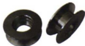
Шкивы ф48х17,3мм ф49,9х17,3мм подшипник: 6000 2RS
