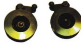
Шкивы с кронштейнами ф49,9х17,3мм подшипник: 6000 2RS
