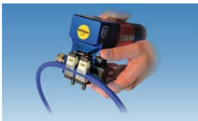
Набор оборудования для соединения ремней трением. Подходит для круглых ремней сечением от 5 мм и клиновых от сечения Z.
