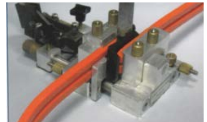
Набор (паяльник+зажим) для соединения круглых и клиновых ремней внахлест.
