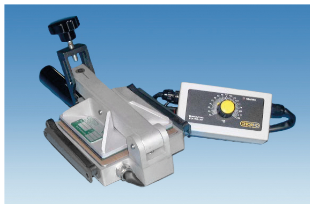
Пресс для соединения плоских полиамидных ремней
