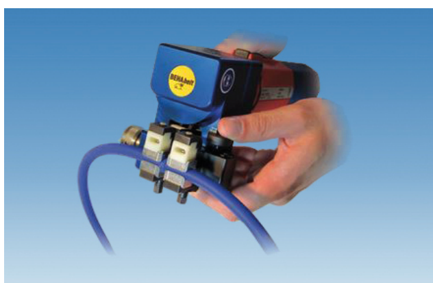
Виброустройство для соединения сварных ремней малых сечений
